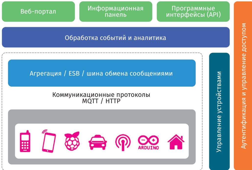
Рис. 8.30. Эталонная архитектура интернета вещей [Munasinghe 2017]
