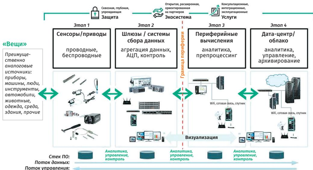
**Рис. 8.31.** Четырехэтапная архитектура решений интернета вещей [Fuller 2016]
